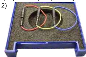
Набор контуров (FP-00357) для тестирования датчика проводимости
